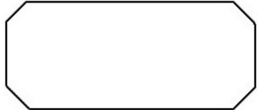
Köşeleri 45° Kesilmiş Loop Alanı (Tavsiye Edilen Kesim Şekli)
